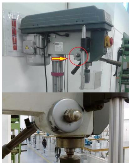
Afrouxar as 2 porcas 1/4 de volta no sentido contrário ao ponteiro do relógio, **nunca desapertar completamente**. Rodar até o perno atingir o próximo encaixe, para aumentar a tensão rodar no sentido dos ponteiros do relógio para diminuir rodar ao contrário
