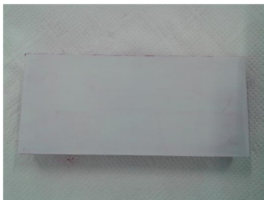
Peça com a aplicação do líquido revelador
